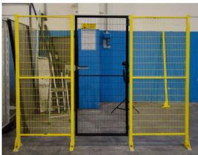
Allo scopo di valutare la capacità della protezione di impedire la fuoriuscita di corpi in movimento, si è valutata la capacità di assorbimento dell'energia d'urto, la capacità di impedire l'attraversamento e la possibilità di riuso della protezione dopo l'urto. È stato approntato un set-up composto da un pendolo a massa sospesa. La massa è costituita in un corpo metallico, di forma cilindrica, diametro 300 mm altezza 400 mm, di massa 21.4kg.
